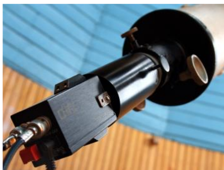
Obr.2: CCD kamera OSCAR upevněná pomocí redukce na dalekohled.
