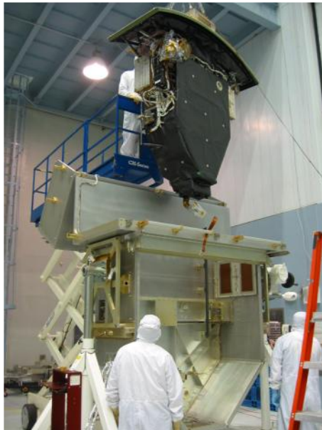
Obr.7: Ukládání nového přístroje WFC 3 do ochranného boxu. [11]
