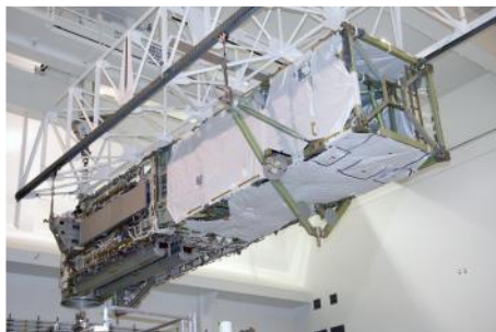
Obr.2: Příprava posledního dílu příhradové konstrukce ITS . [8]
