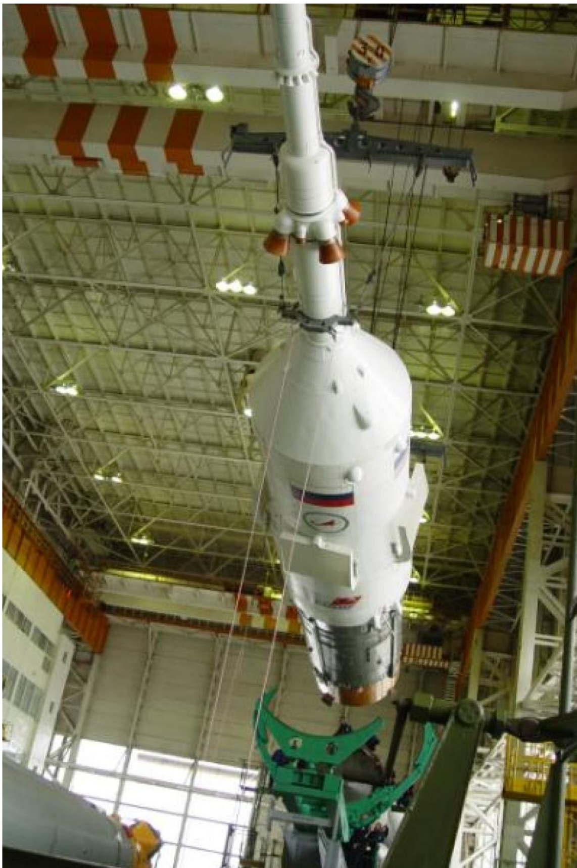
Obr.3: Integrace kosmické lodi Sojuz TMA-14 na nosnou raketu. [9]
