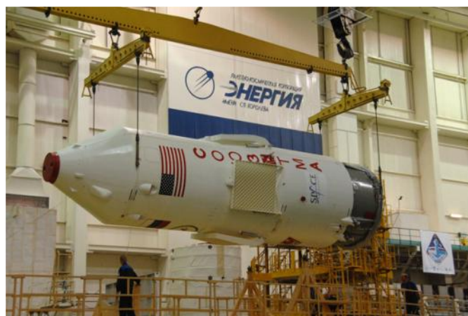
Obr.3: Kosmická loď Sojuz TMA-13 ukryta pod aerodynamickým krytem a připravena k montáži na nosnou raketu. [9]
