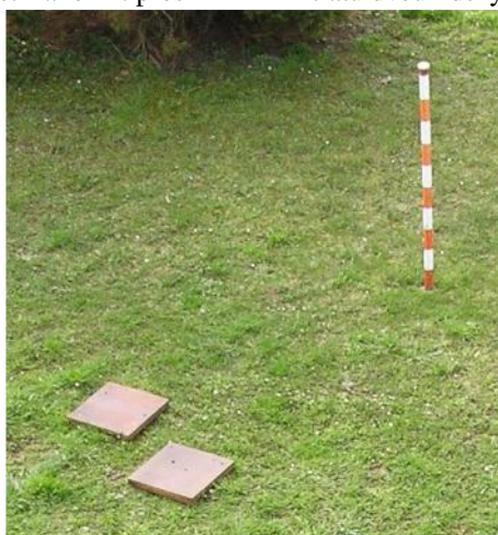
Obř.1: Sněhoměrná laň a sněhoměrné desky. V zimě 2007/08 byly díky nedostatku sněhu na Vsetínsku téměř „bez práce“. Foto: Emil Březina
