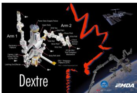
Obr.4: Zakončení staničního manipulátoru SSRMS nazvané Dextre . [3]
