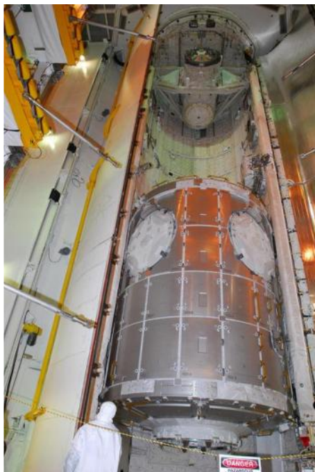
Obr.2: Nákladový prostor raketoplánu při misi STS-120 Discovery . Nahoře je stykovací uzel ODS a pod ním modul Node 2 ( Harmony ), na jehož boku můžete vidět stykovací uzly. [9]
