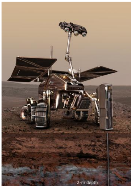
Obr.2: Kresba roveru ExoMars , vidět je i vrtačka pro odběr vzorků z podpovrchových oblastí. Kresba ESA . [5]
