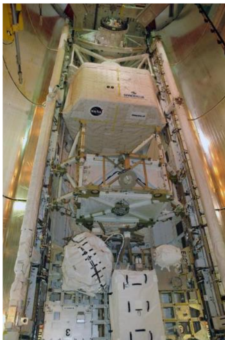
Obr.2: Nákladový prostor raketoplánu. Nahoře je stykovací uzel ODS , pod ním modul Spacehab , pak ITS S5 a dole vlevo v bílém kulovém obalu gyroskop CMG a vedle něj na pravé straně plošina ESP-3 . [10]
