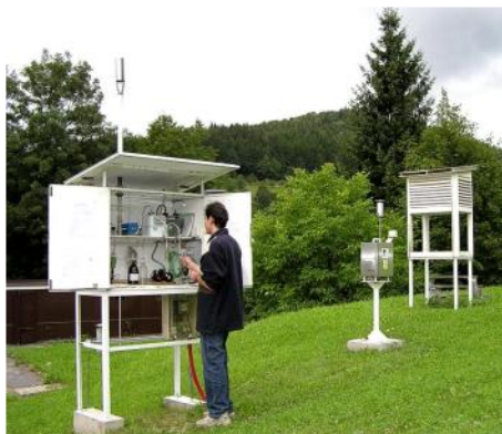
Obr.4: Zleva stanice na měření čistoty ovzduší, zařízení na stanovení množství prašného aerosolu ve vzduchu a stará meteorologická budka. Foto: Emil Březina
