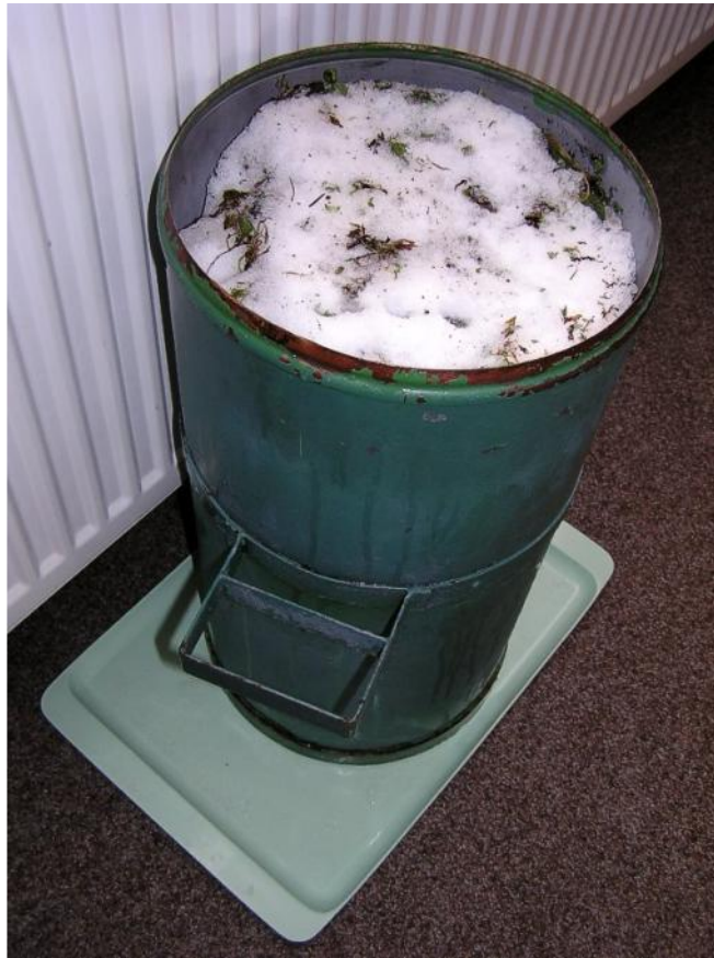
Obr.5: Srážkoměr s odebraným sněhem pro změření vodní hodnoty celkové sněhové pokrývky při její rekordní výšce v únoru 2006. Foto: Emil Březina
