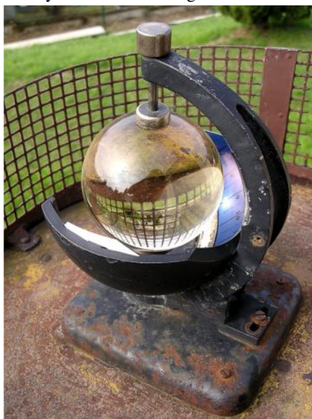
Obr.2: Heliografem byla do roku 2005 měřena délka slunečního svitu. Foto: Emil Březina
