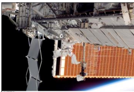
Obr.4: Astronaut Patrick Forrester asistuje při skládání solárního panelu na ITS P6. [12]
