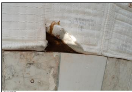
Obr.3: Poškození nomexové obšívky na levém modulu motoru OMS. Oprava proběhla v rámci třetího výstupu do kosmu. [11]
