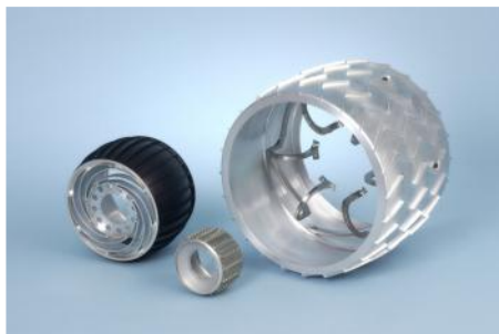
Obr. 10: Srovnání kol roverů MER (vlevo), Sojourner (uprostřed) a MSL (vpravo). [40c]
