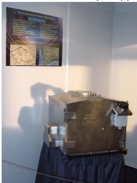
Obr.4: Nová automatická celoooblohová komora pro středoevropskou bolidovou síť. Foto: Jiří Srba
