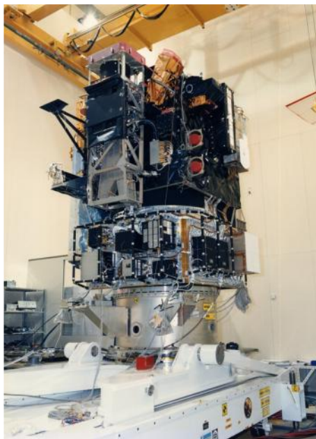
Obr.1: Kompletace vědeckého modulu sondy SOHO. [8]
