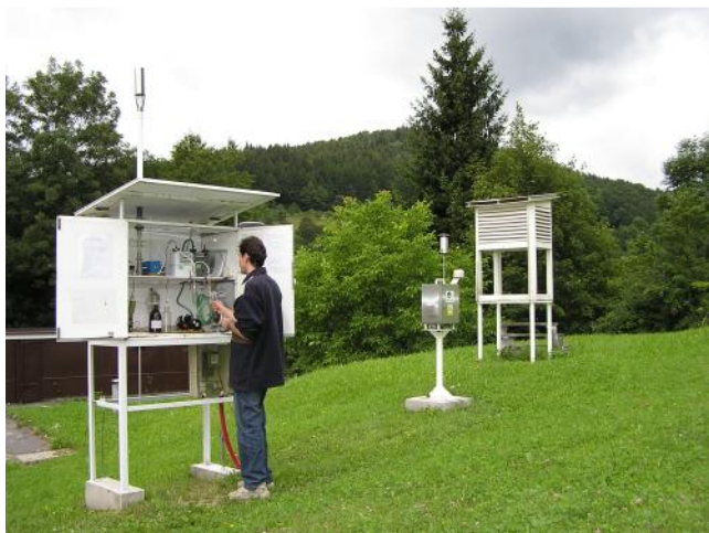
Obr.7: Zleva stanice na měření znečištění ovzduší, zařízení na stanovení množství prašného aerosolu ve vzduchu a stará meteorologická budka, srpen 2005.
