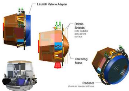
Obr.4: 3D model impaktního zařízení sondy Deep Impact. [5]
