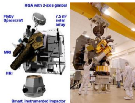
Obr.2: 3D model sondy Deep Impact a její reálný vzhled — na závěsu v laboratoři, kde byla složena. V horní části se nachází mateřské těleso, v dolní impaktor. [5]
