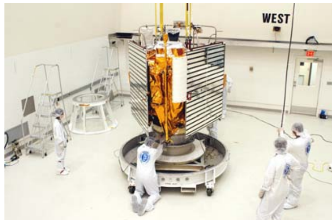
Obr.1: Kompletní sonda MESSENGER je připravena k montáži na nosnou raketu Delta 7925H . [8]
