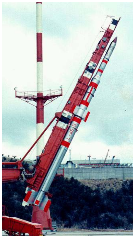
Obř.2: Příprava japonské pětistupňové rakety Lambda-4S využívající motory na tuhé pohonné látky. [7]
