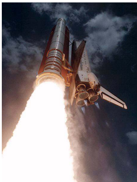
Obr.1: Start amerického raketoplánu Atlantis k misi STS-71. Na snímku lze vidět trojici kyslíkovodíkových motorů SSME a jeden motor SRB na tuhé pohonné látky. [6]
