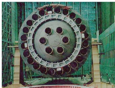
Obr.3: První stupeň neúspěšné ruské rakety N-1 pohánělo 30 motorů NK-15, jejichž trysky lze spatřit na snímku. [8]
