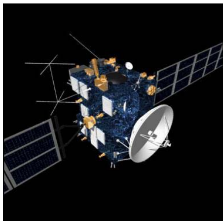
Obr.1: Sonda Rosetta v čelním pohledu. Na přední straně těla sondy je umístěna vysokozisková parabolická anténa o průměru 2,2 m sloužící ke komunikaci se Zemí. [2]
