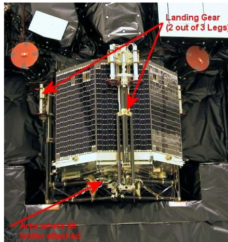
Obr.4: Detail modulu Philae , jehož úkolem je přistání na povrchu komety 67P. Šipkami je vyznačen brzdící (tlumicí) mechanismus a poloha nově vloženého dílu – omezovače náklonu. [1]
