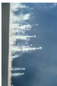
Obr.3: Aerogel, materiál se speciálními vlastnostmi je použit pro kolekci prachu, který se pohybuje vysokou rychlostí vůči sondě. Na obrázku vpravo jsou vidět kanálky vyhloubené zbržděnými zrníčky
