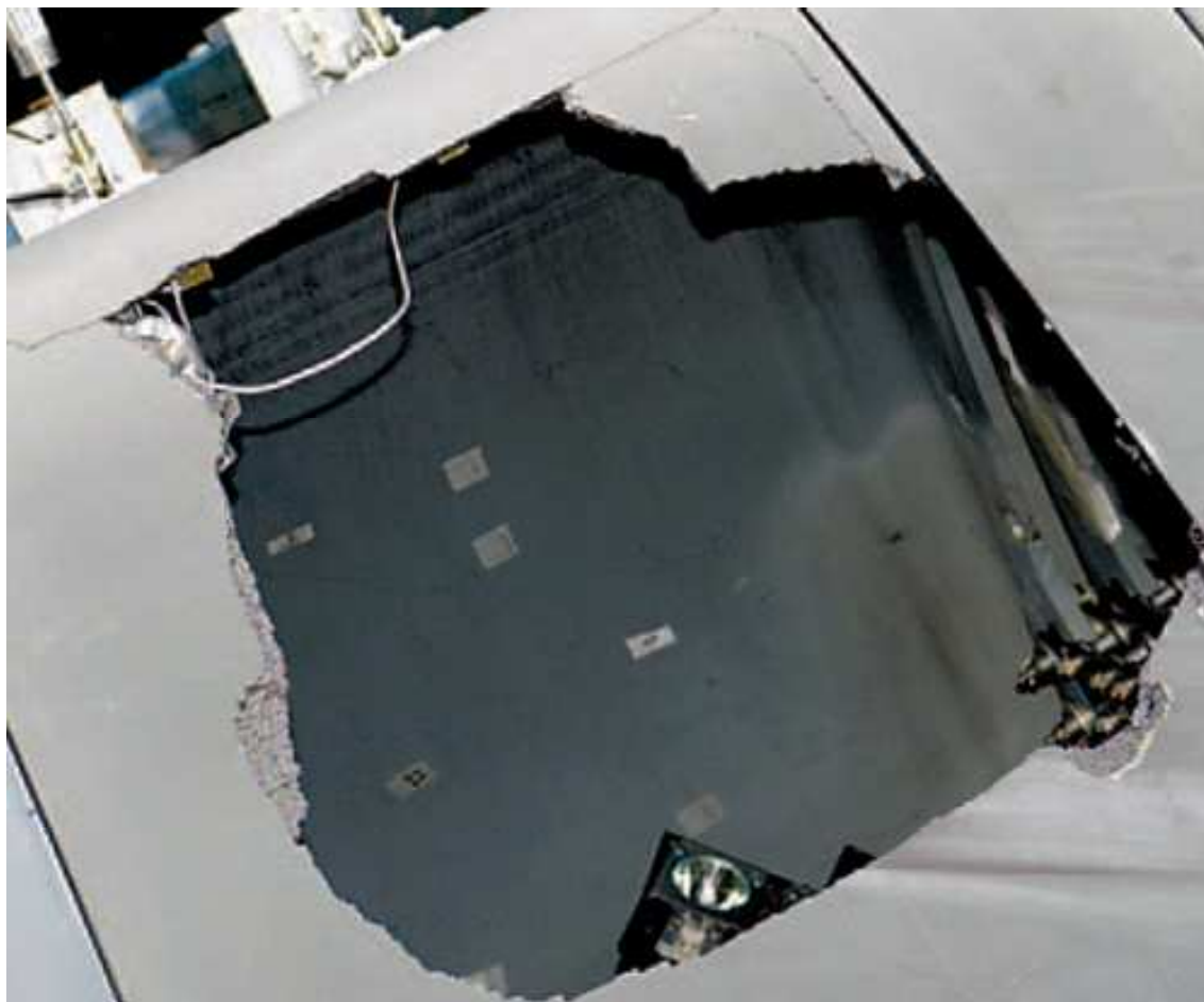
RCC panel proražený kusem izolační pěny při pozemních testech prováděných po havárii Columbie .
