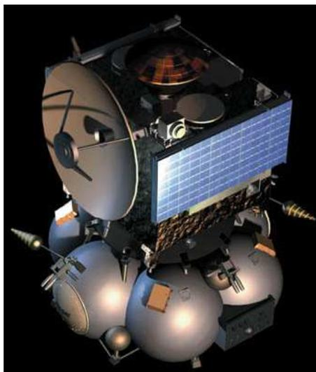
Sonda *Mars Express* umístěná na horním stupni *Fregat*. Na vrcholu sondy je vidět přistávací pouzdro s modulem *Beagle 2*.
