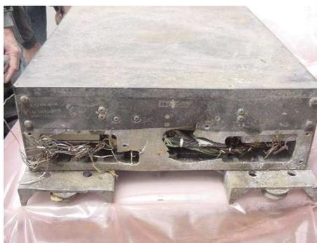
Záznamové zařízení OEX (Orbiter Experiment Support System) bylo nalezeno 19.3.2003 u městečka Hemphill v Texasu. OEX zaznamenává data o teplotě, tlaku, vibracích, atd. nezávisle na síti čidel telemetrie.
