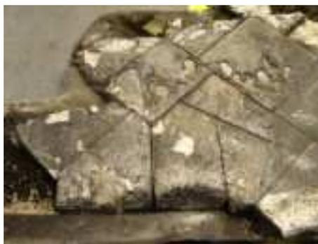
Dlaždice tepelné ochrany z oblasti levé podvozkové šachty raketoplánu. Je na nich dobře patrná míra destrukce způsobená neřízeným letem atmosférou.
