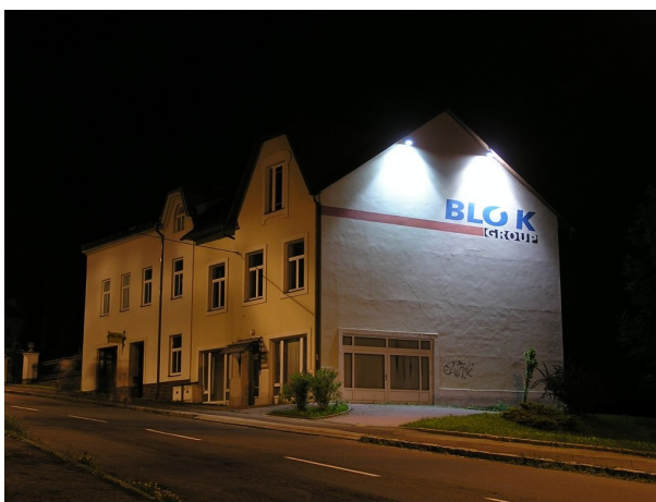
Obr. 3: Ukázka dobře nasvícené reklamy, kdy je zdroj světla umístěn nad reklamou a svítí shora dolů. Intenzita světla je ale zbytečně vysoká.
